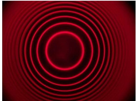
Fig. 7: Livebild mit Fabry-Pérot-Etalon
