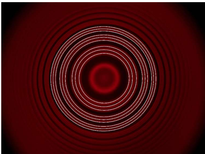
Fig. 5: Triplet-Aufspaltung der roten Cadmium-Linie ( I = 5,0 \text{ A} \triangleq B = 458 \text{ mT} ). Mit Kreisen markierte Interferenzringe zur Bestimmung der eingeschlossenen Flächen
