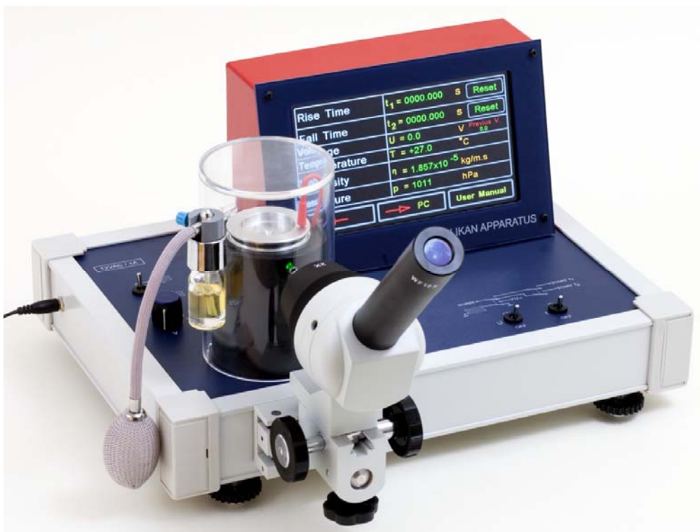
Fig. 1: Aparato de Millikan
