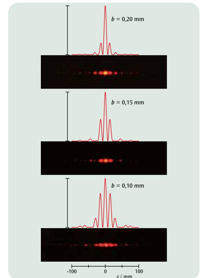
Fig. 2: Intensidade calculada e observada na difração em fendas duplas com diversas distâncias entre fendas
