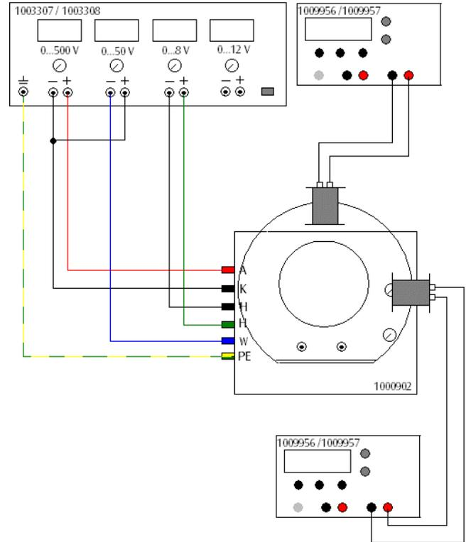
Fig. 4: Colocación y cableado de las bobinas.
