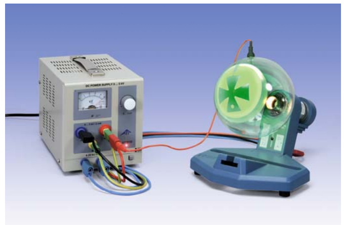
Fig. 2 Experimenteller Aufbau zur Demonstration der geradlinigen Ausbreitung von Elektronen mit der Schattenkreuzröhre
