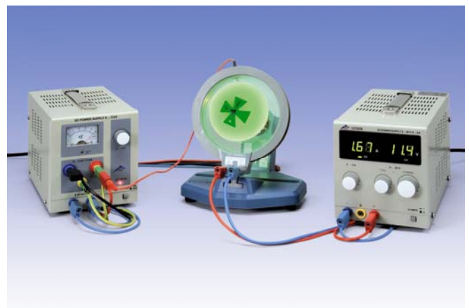
Fig. 3: Modifizierter experimenteller Aufbau mit zusätzlichem axialem Magnetfeld
