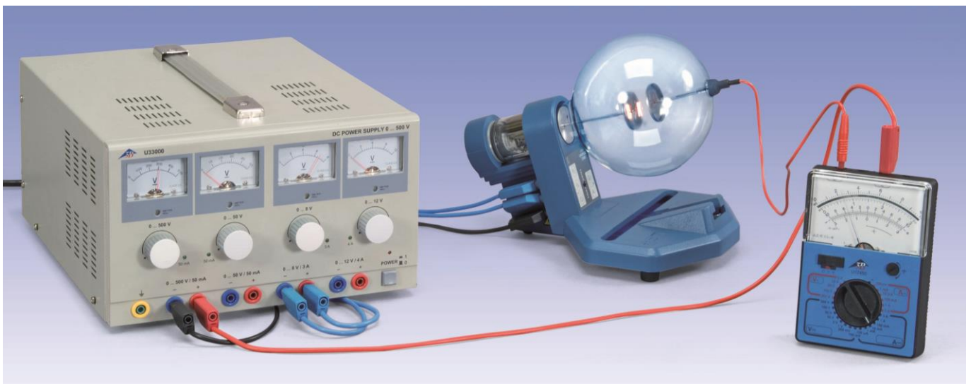
Fig. 1: Circuit (en haut) et montage expérimental (en bas) pour l'enregistrement des caractéristiques d'une diode à tube avec trois tensions de chauffage cathodiques différentes. (1) Cathode, (2) Anode
