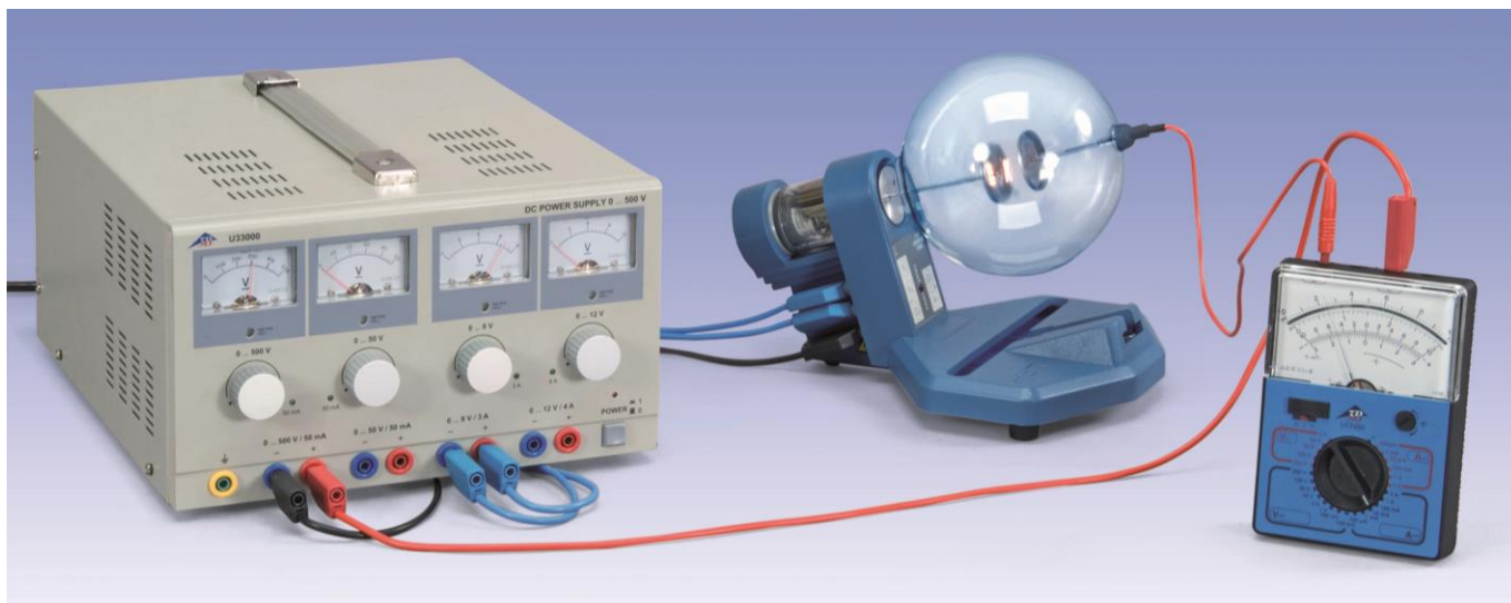
Fig. 1: Circuito (arriba) y montaje experimental (abajo) para el registro de las curvas características de un diodo de tubo con diferentes tensiones de calentamiento de cátodo. (1) cátodo, (2) ánodo.
