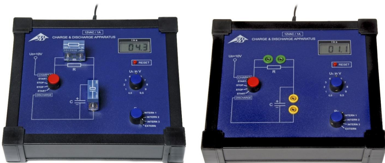
Fig. 1: Equipo de carga y descarga en funcionamiento con combinación de resistencia y condensador externo (izquierda) e interno (derecha)
