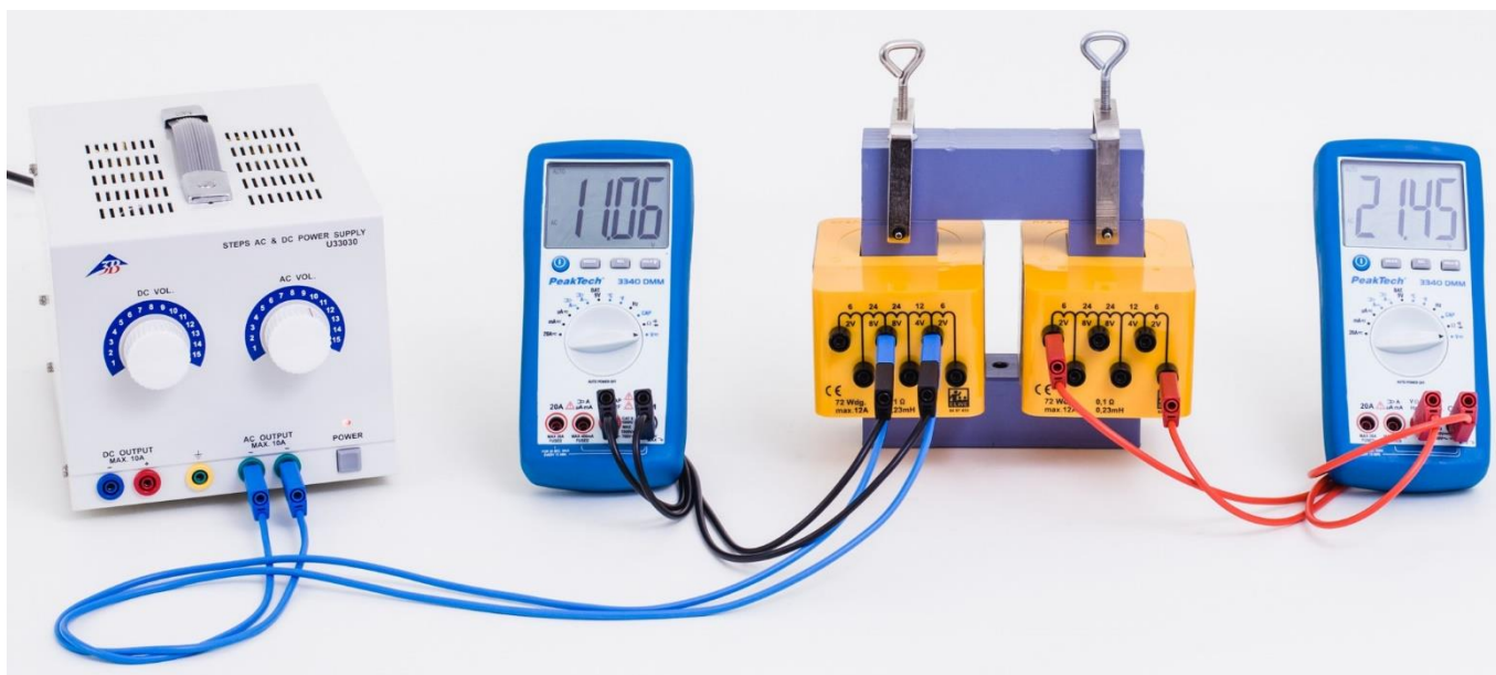
Fig. 1 : Dispositif de mesure de la tension à vide en fonction de la tension primaire.
