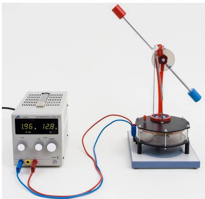
Fig. 5: Montagem para a operação do motor de ar quente como máquina de força térmica através de um aquecedor elétrico
