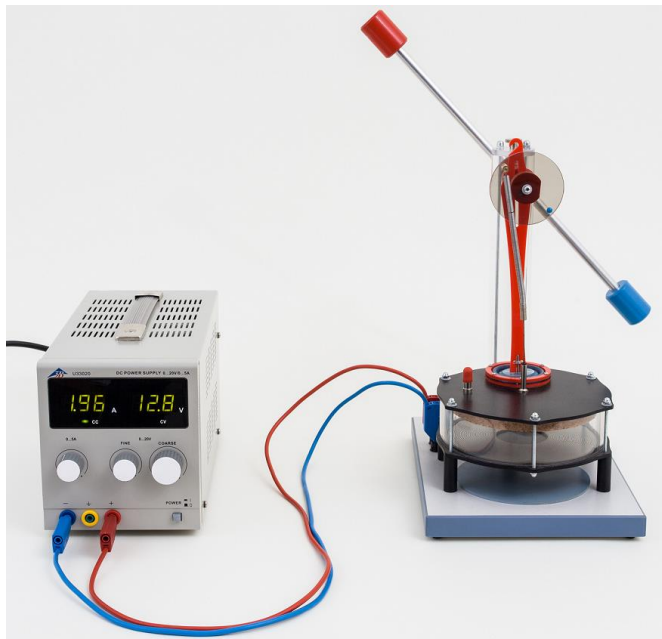
Fig. 5: Aufbau zum Betrieb des Heißluftmotors als Wärmekraftmaschine durch elektrische Heizung
