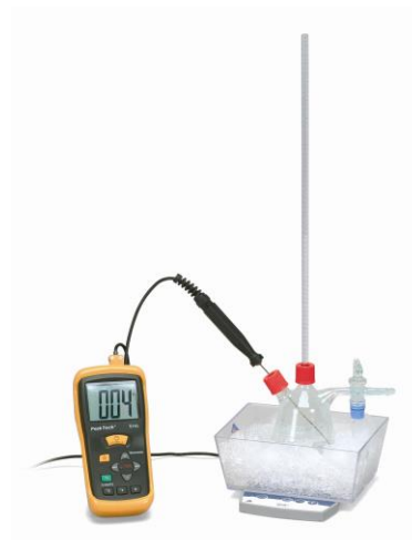
Fig. 2: Montagem experimental para a determinação da temperatura de densidade máxima da água
