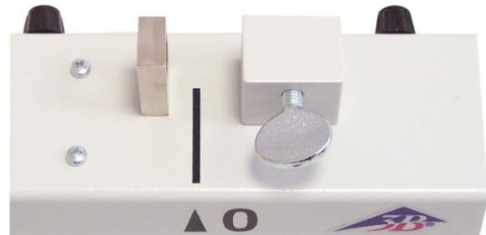
Fig. 4: Parafusar o adaptador para o relógio medidor.
