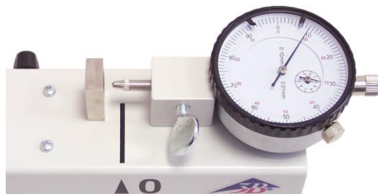
Fig. 5: Die Messuhr vollständig in den Adapter einführen und mit der Flügelschraube fixieren.
