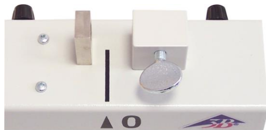
Fig. 4: Den Adapter für die Messuhr anschrauben.
