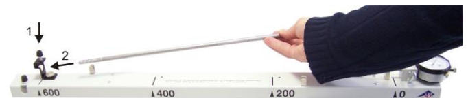
Fig. 6: Das Festlager mit der Rändelschraube bei der Markierung 600 auf dem Längenausdehnungsapparat befestigen. Das Probenrohr aus Stahl mit dem offenen Ende in das Festlager legen.
