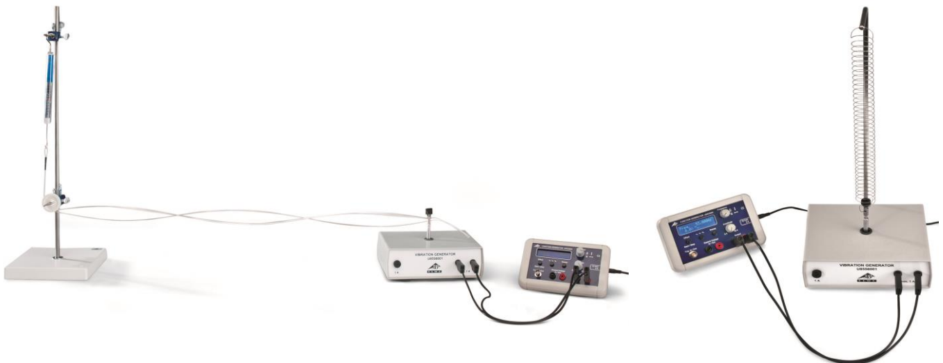
Fig. 1: Agencement de mesure pour l'étude d'ondes stationnaires sur une corde tendue (à gauche) et un ressort hélicoïdal tendu (droite).
