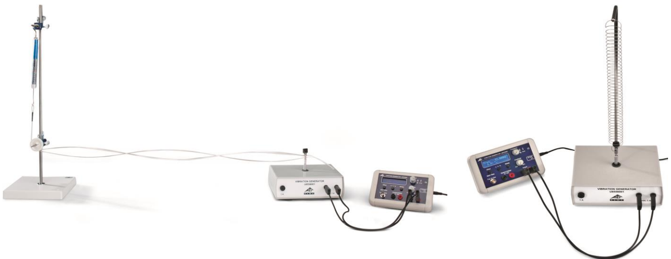
Fig. 1: Disposición de medición para el estudio de las ondas estacionarias en una cuerda tensa (izquierda) y en un muelle helicoidal tenso (derecha).
