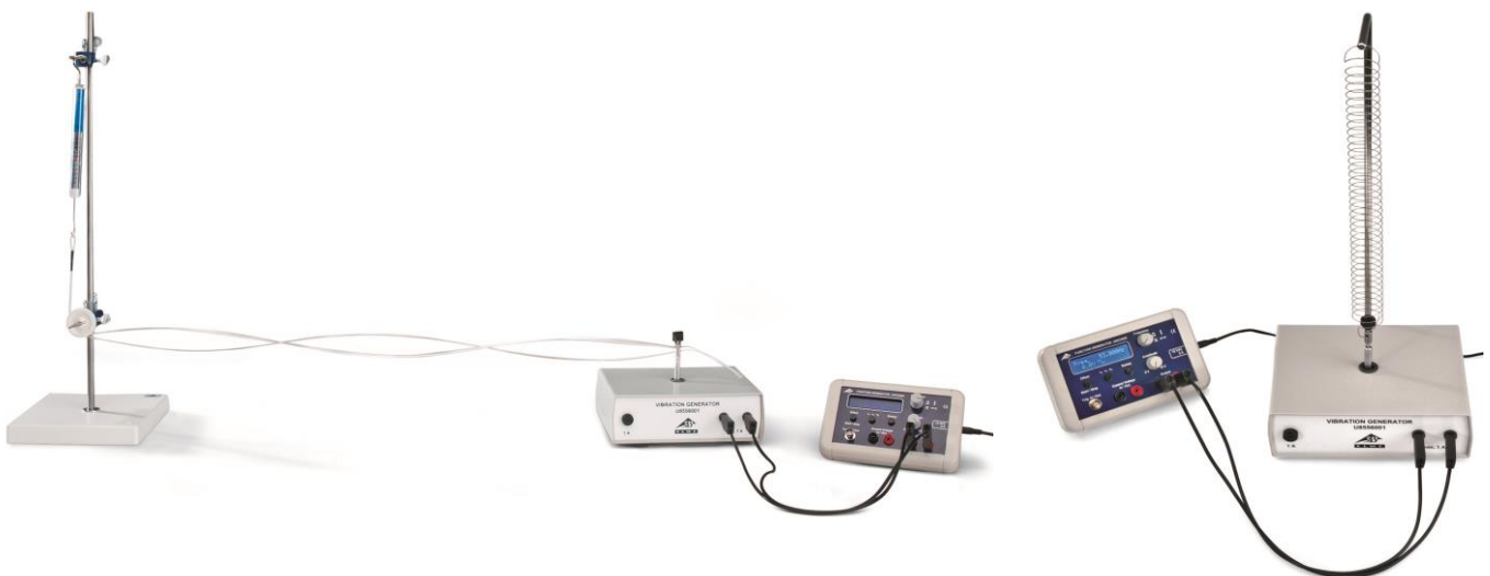
Fig. 1: Messanordnung für die Untersuchung von stehenden Wellen auf einem gespannten Seil (links) und einer gespannten Schraubenfeder (rechts).
