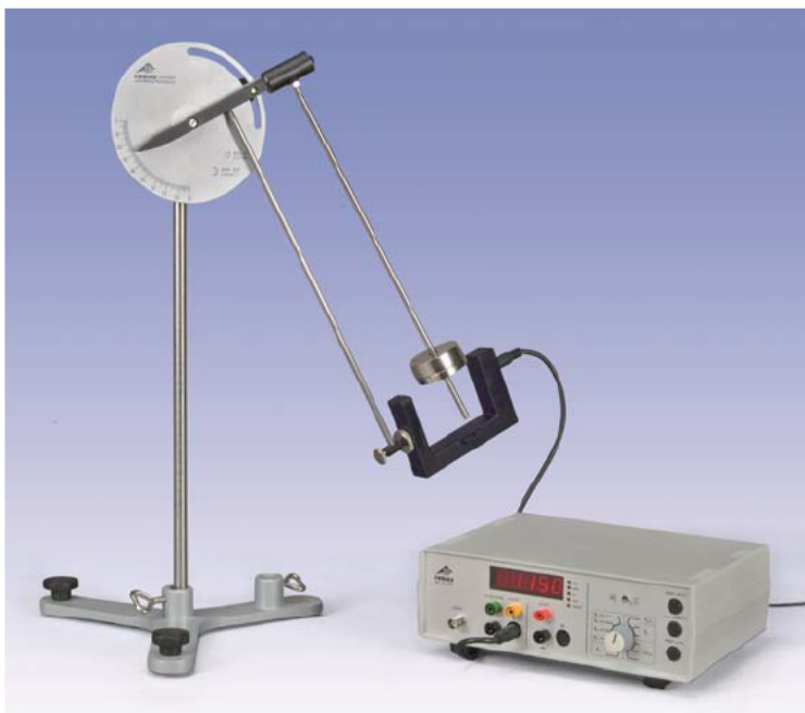
Fig. 1: Péndulo de aceleración variable (fotografía y representación esquemática)
