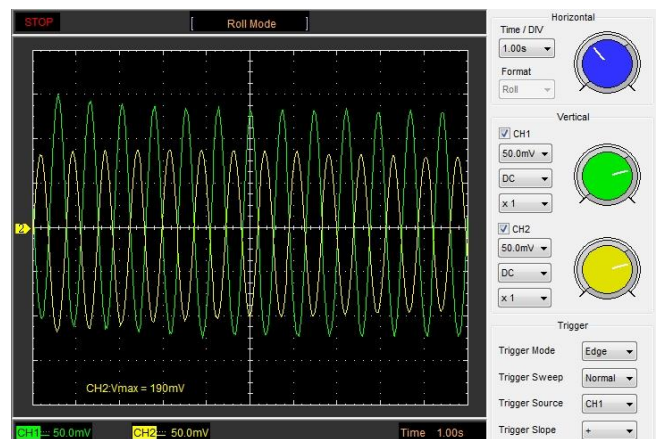
Fig. 8: Componentes de oscilação do pêndulo suspenso por fio em oscilação "perpendicular ao bisetor"
