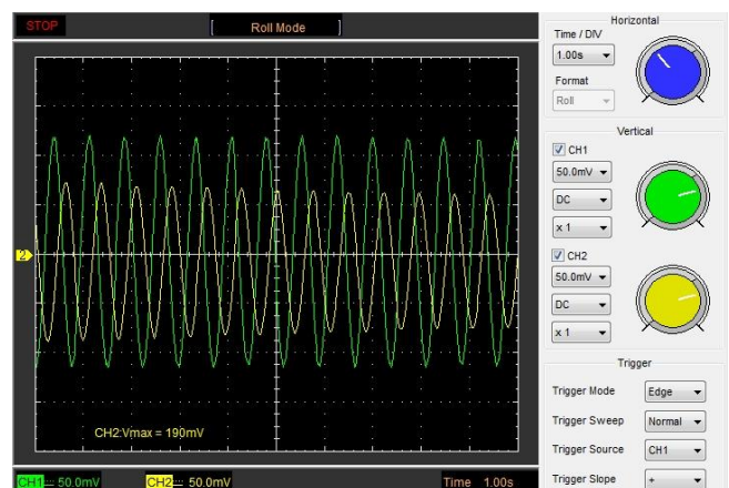
Fig. 9: Componentes de oscilação do pêndulo suspenso por fio em oscilações circulares
