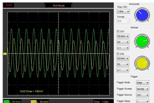
Fig. 9: Schwingungskomponenten des Fadenpendels bei kreisförmigen Schwingungen.
