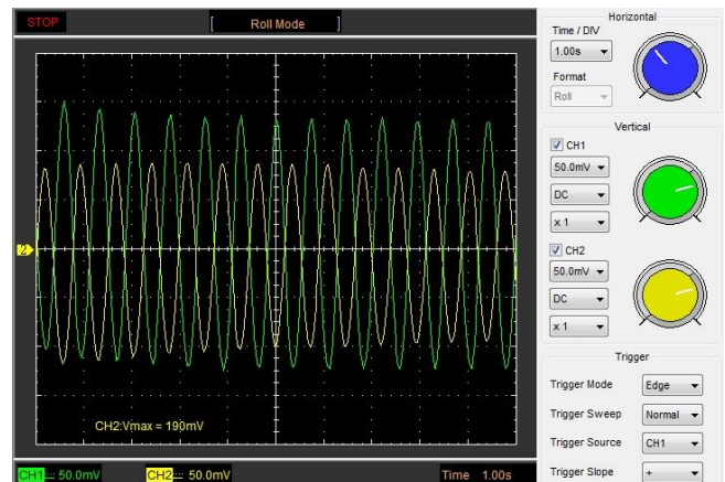
Fig. 8: Schwingungskomponenten des Fadenpendels bei Schwingung „senkrecht zur Winkelhalbierenden“.
