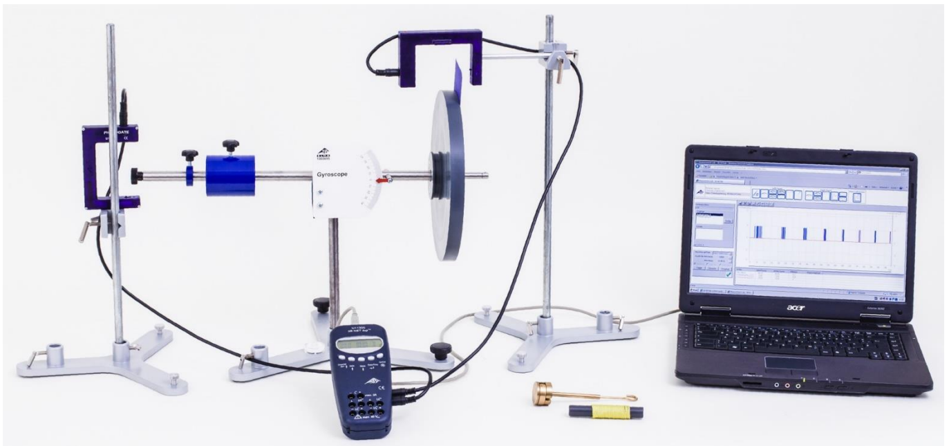
Fig. 1: Disposición de medición para la precesión de un giroscopio (sin masa adicional colgada)
