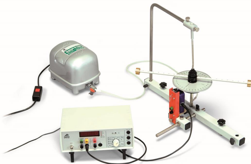
Fig. 1: Messanordnung zur Bestimmung des Trägheitsmoments nach der Drehschwingungsmethode
