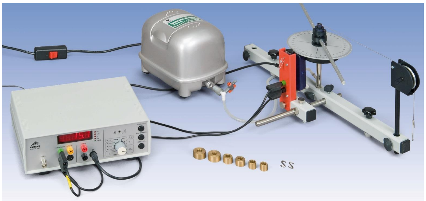
Fig. 1: Messanordnung zur Untersuchung gleichmäßig beschleunigter Rotationsbewegungen
