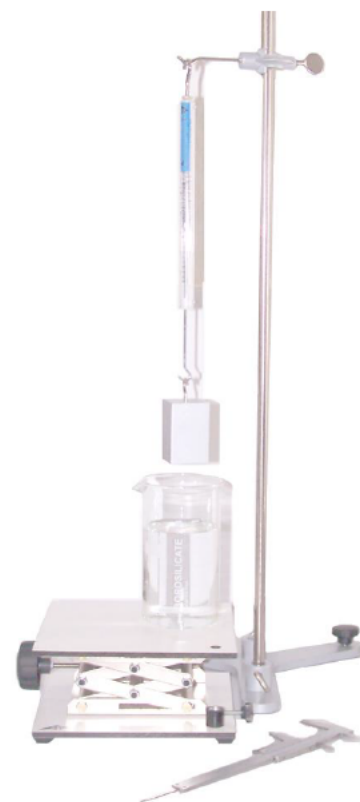
Fig. 1 Determinação da força ascensional sobre um sólido.
