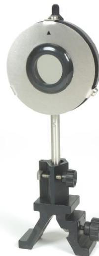
Fig. 1: Anexo de polarização montado sobre a placa de comprimento de quarto de onda.
