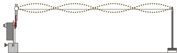
Onda estacionaria ( n = 4 ) con reflexión en el extremo fijo
