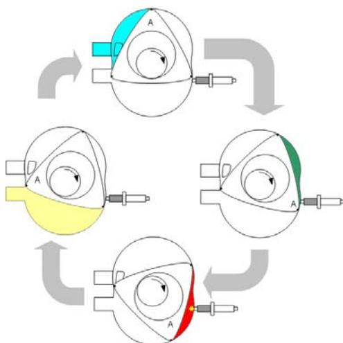
Fig. 1: Tiempos de trabajo del motor Wankel:
