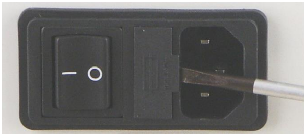
Fig. 3: Remplacement de fusible
