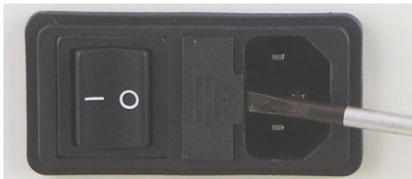
Fig. 3: Reemplazo de fusibles
