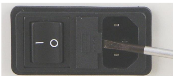
Fig. 3: Sostituzione dei fusibili
