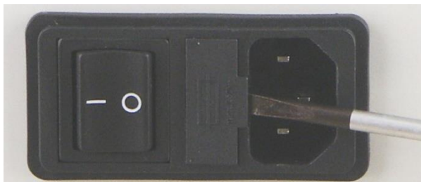
Fig. 3: Troca de fusíveis
