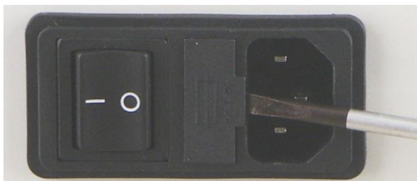
Fig. 3: Reemplazo de fusibles
