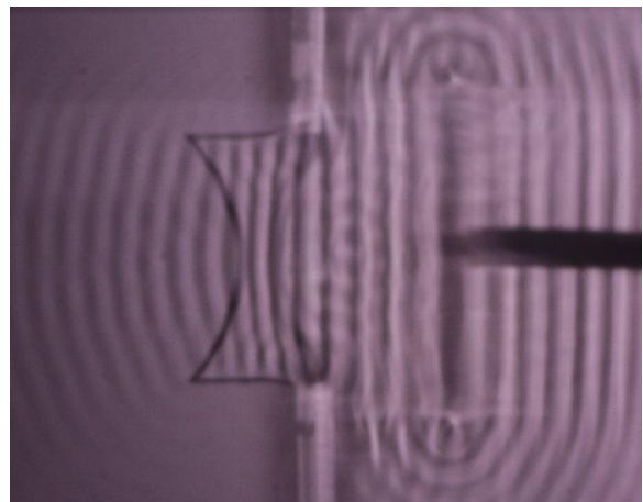
Fig. 2b: Refracción de ondas planas en una lente bicóncava. Los bordes frontales de la lente están protegidos por dos cubos largos colocados en posición vertical para minimizar los efectos indeseados en los bordes, como los fenómenos de difracción e interferencia.
