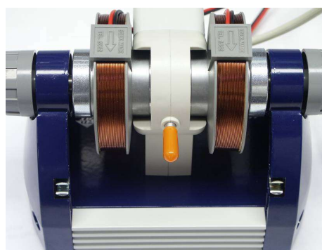
Fig. 2 Unità base con campione DPPH inserito
