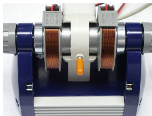
Fig. 2 : Console avec échantillon de DPPH inséré
