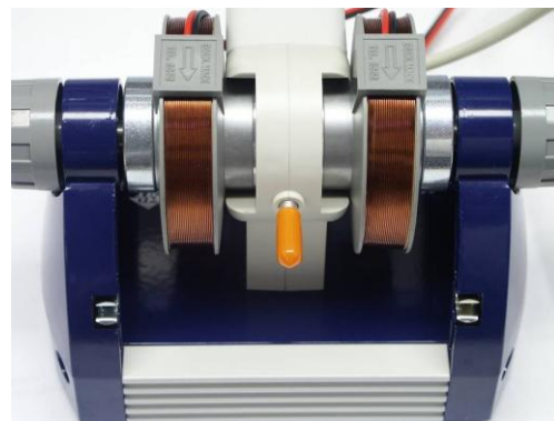
Abb. 2: Basiseinheit mit eingesteckter DPPH-Probe
