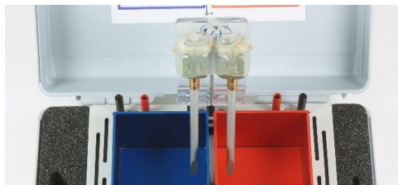
Fig. 2 Unidade de agitação conectada com hastes de agitação colocadas
