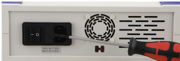
Fig. 2 Troca de fusíveis
