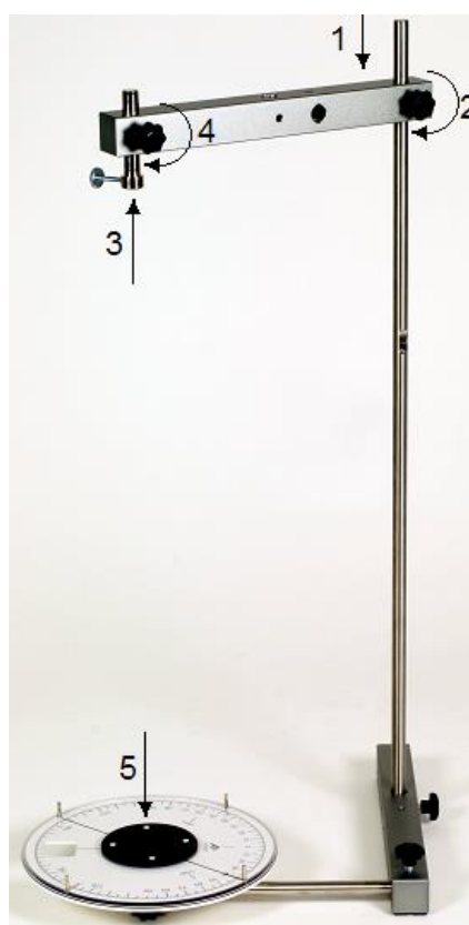
Fig. 4: Montagem da travessa superior (para barra redonda com L: 500 mm), luva de aperto e disco de pêndulo.
