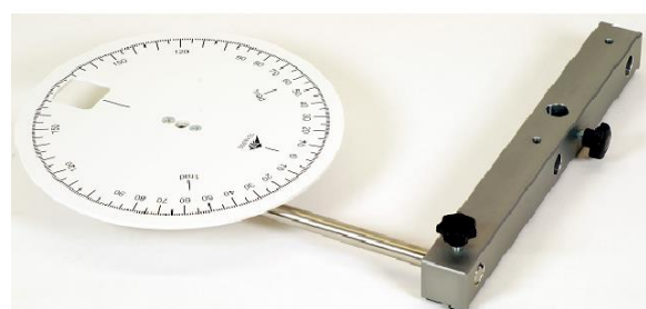
Fig. 2: Montagem do disco de escala e da travessa inferior na haste transversal.
