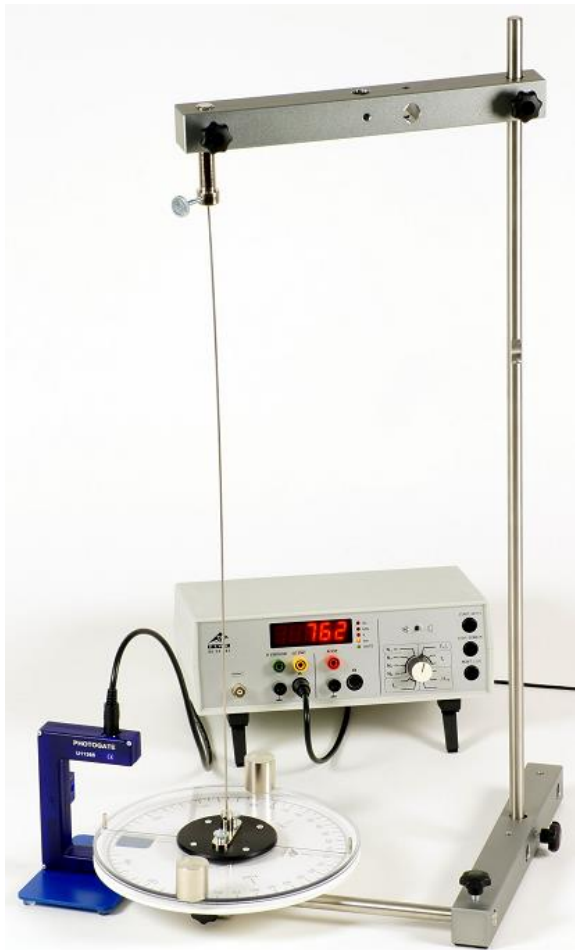
Fig. 10: Medição dinâmica com uma fotocélula e um contador digital.
