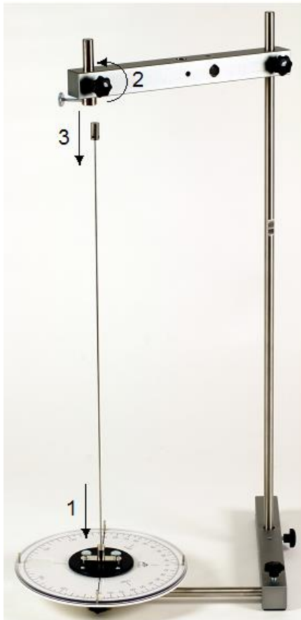
Fig. 5: Fixação da barra redonda no disco de pêndulo com auxílio do retentor e colocação da luva de aperto sobre o cilindro da luva de aperto.
