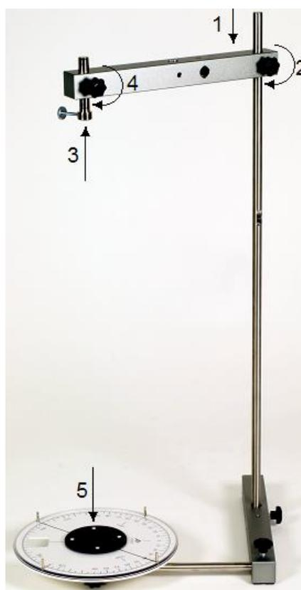
Fig. 4: Montagem da travessa superior (para barra redonda com L: 500 mm), luva de aperto e disco de pêndulo.
