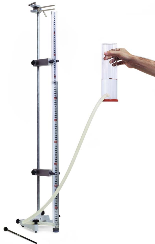
Fig. 1: Tubo de ressonância de Quincke em operação.
