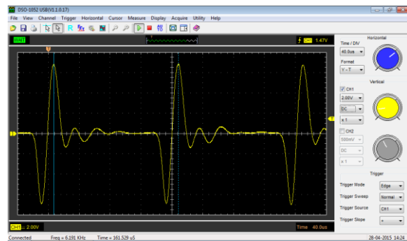
Fig. 2 Paquetes de oscilaciones en una barra de acero inoxidable de 400 mm de longitud despu3s de una excitaci3n en forma de impulso
