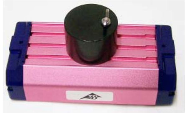
Fig. 23 Massa adicional montada
