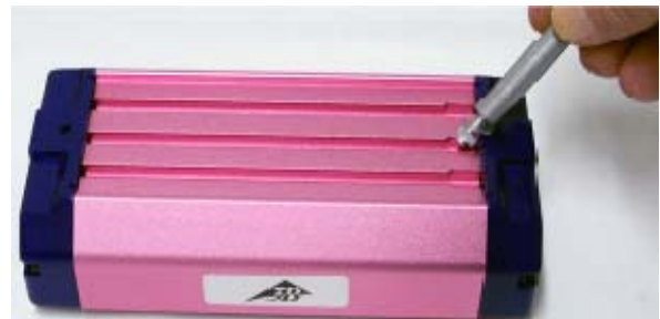
Fig. 24 Colocação do interruptor na ranhura na parte de cima do carrinho
