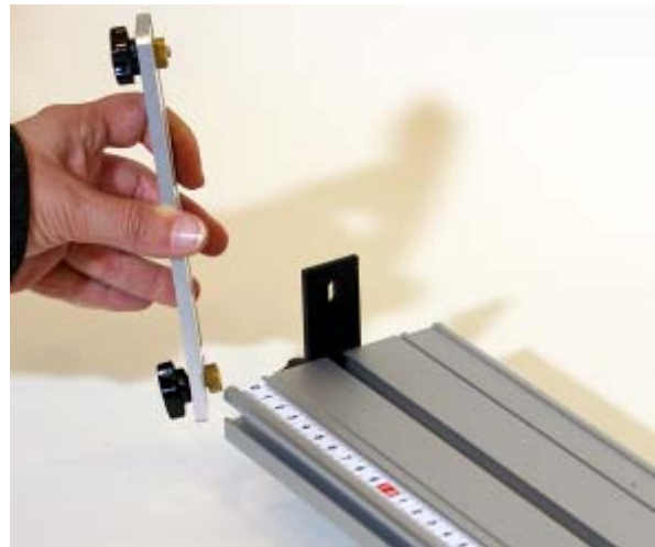
Fig. 16 Colocação do suporte para a célula fotoelétrica na ranhura lateral do trilho de rolagem
