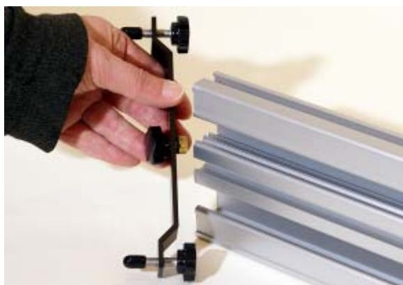
Fig. 5 Colocação do apoio de dois pontos na ranhura central na parte inferior do trilho de rolagem
