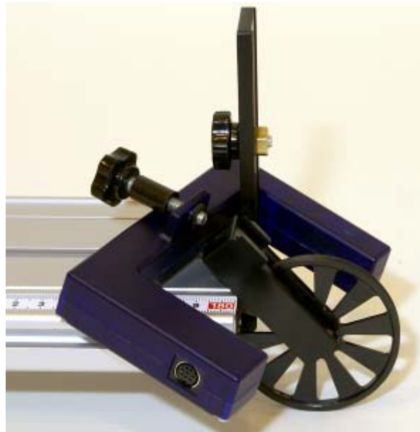
Fig. 11 Montagem da roda de desvio na célula fotoelétrica
