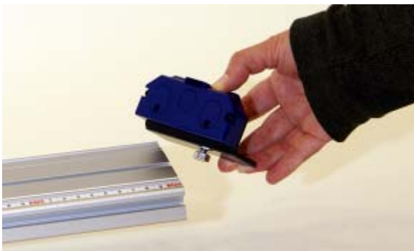
Fig. 14 Colocação do terminal com receptáculo de imã na ranhura na parte de cima do trilho de rolagem
