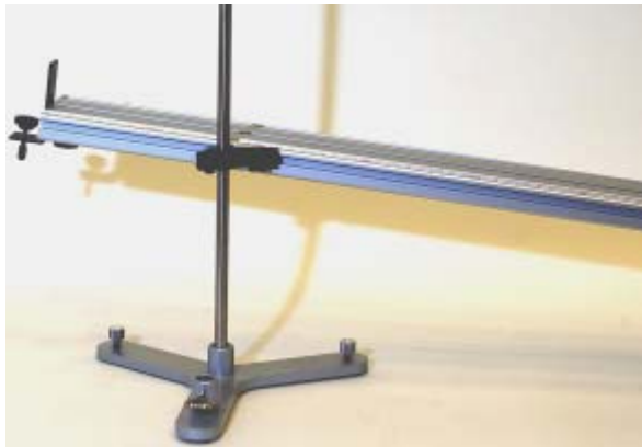
Fig. 20 Manga para hastes montada na ranhura lateral do trilho de rolagem
