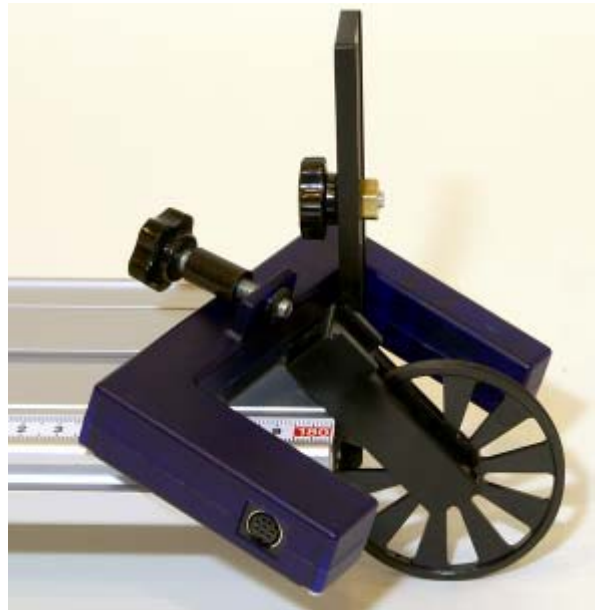
Fig. 11 Montaje de la polea de desviación en la puerta fotoeléctrica
