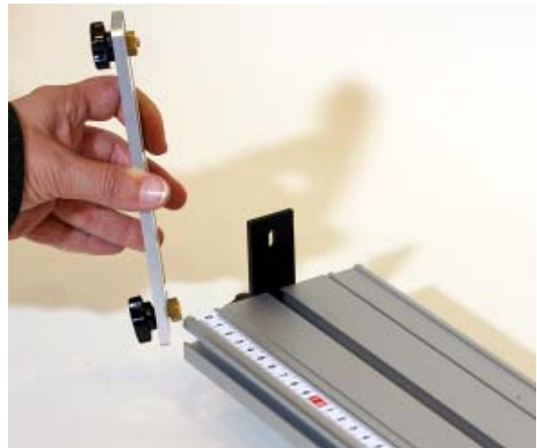
Fig. 16 Colocación del soporte para puerta fotoeléctrica en la ranura lateral del carril
