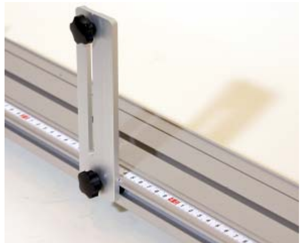
Fig. 17 Soporte para puerta fotoeléctrica montado
