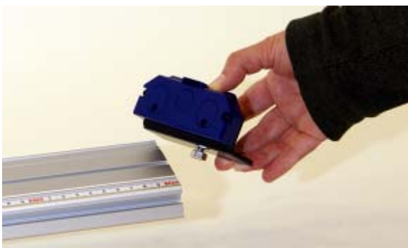
Fig. 14 Colocación de la pieza extrema con alojamiento para imán en la ranura en la parte superior del carril
