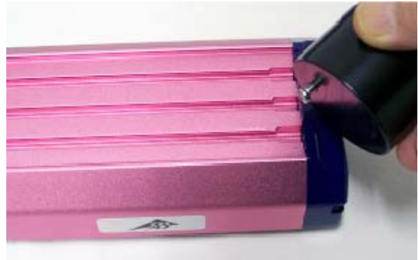
Fig. 22 Colocación de la masa adicional en la ranura de la parte superior del carro
