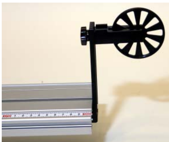
Fig. 9 Polea de desviación ya montada
