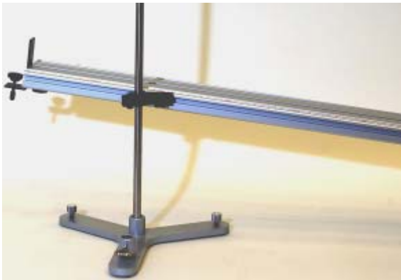
Fig. 20 Manguito para varillas ya montado en la ranura lateral del carril
