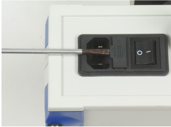
Fig. 1 Troca de fusíveis
