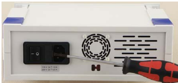
Fig. 1 Reemplazo de fusibles
