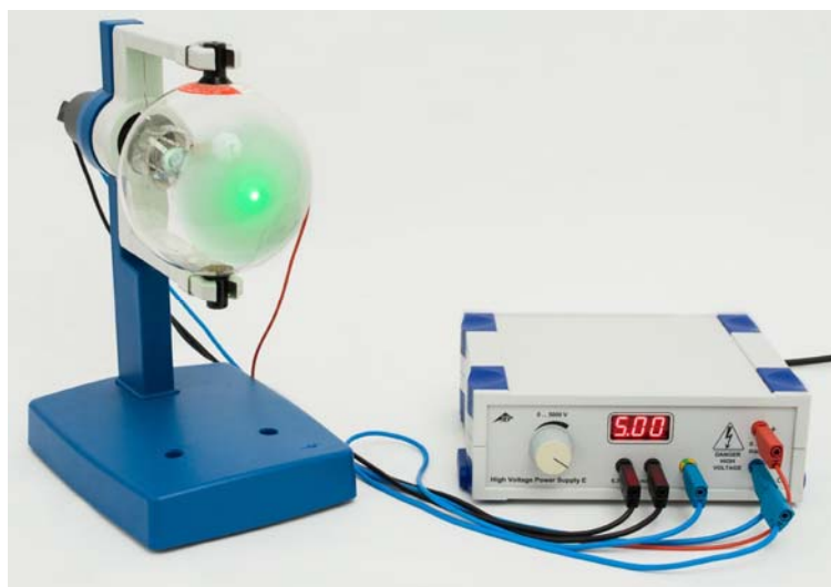
Fig. 2 Funcionamiento del tubo de difracción de electrones
