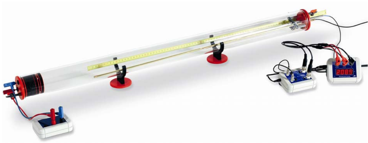
Fig. 2: Montagem do experimento com tubo de Kundt
