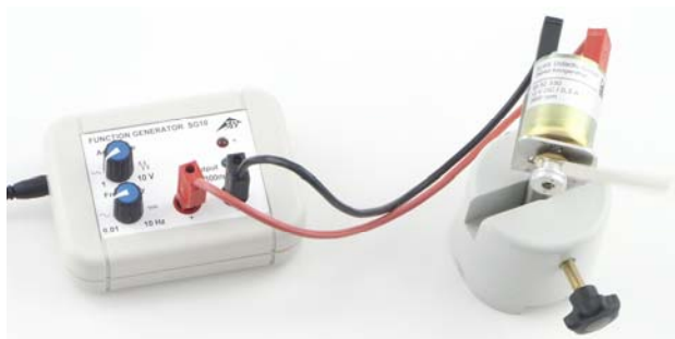
Fig. 1 Montaje experimental para demostrar el cambio de la dirección de rotación de un motor de corriente continua
