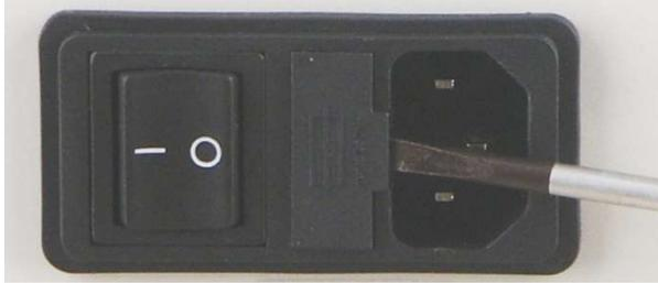
Fig. 3: Reemplazo de fusibles
