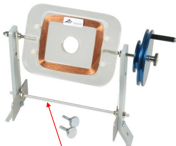
Fig. 1: Bloqueo de transporte para la bobina plana en marco giratorio
