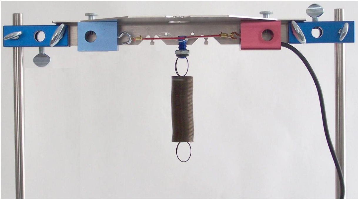
Fig.4 Montagem da transversal no suporte
